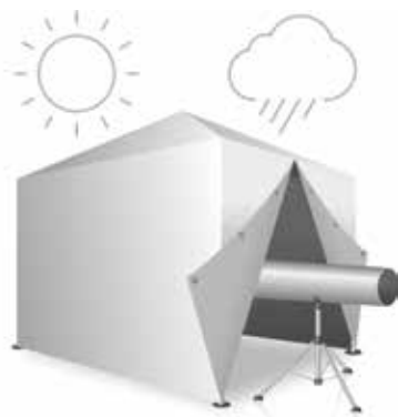
Abbildung C.1: Vorbereitung des Schweißplatzes nach DVS
