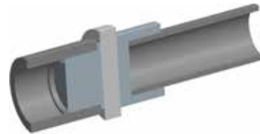
Abbildung C.8: Angleichen und Anwärmen
