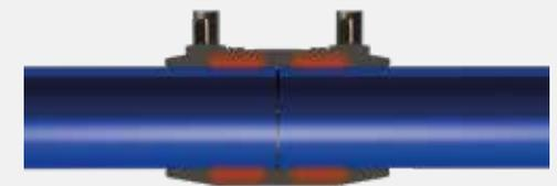
Homogene und dauerhafte Schweißverbindung durch schonende und gleichmäßige Wärmeverteilung.
