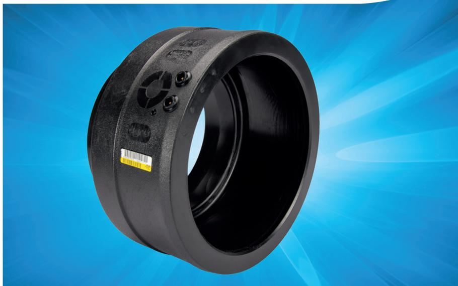
Die AGRU E-Anschweißmuffe ist ein innovativer Heizwendelformteil zum Aufschießen auf PE 100 / PE 100-RC Rohre und Stutzenformteile. Damit können ganz individuell und flexibel Heizwendelformteile in größeren Dimensionen erstellt werden, welche auf der Baustelle, z.B. bei beengten Platzverhältnissen für einen erheblichen Verlegevorteil sorgen. Die E-Anschweißmuffe ist einzeln, als auch vorgeschweißt in folgenden Ausführungen erhältlich:
