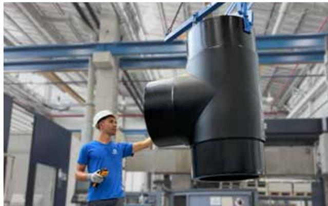
Das formgespritzte T-Stück d<sub>a</sub> 630 setzt neue Maßstäbe im Rohrleitungsbau
