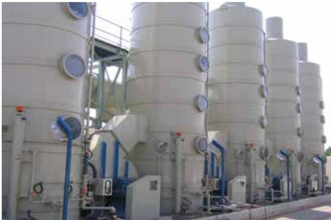
PP ist der ideale Werkstoff für den Einsatz in Beizanlagen, in der chemischen Industrie, als auch für hochaggressive Abwässer, da in diesen Bereichen Chemikalien bei hohen Temperaturen verwendet werden. Das Lieferprogramm von AGRU beinhaltet verschiedene PP Polymertypen:
