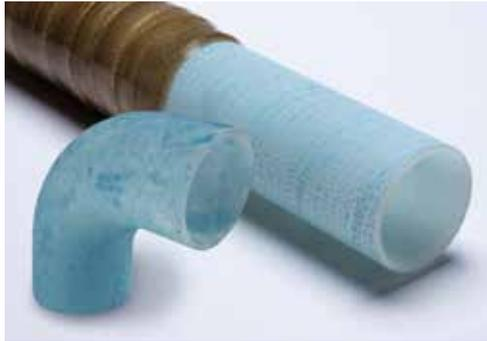
Der PVDF HV-Liner von AGRU ist eine kostengünstige Alternative zu den klassischen kaschierten Rohren. Das oberflächenbehandelte PVDF Rohr weist eine dreidimensionale Oberflächenstruktur auf, die eine optimale Verbindung zum GFK-Rohr ermöglicht. Die Rohrleitungssysteme sind in den Materialien PVDF, PVDF-FLEX und PVDF-el ESD erhältlich. Es können Rohre in den Dimensionen 20 – 400 mm hergestellt werden.
